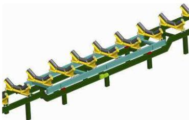
采用全悬浮式六托滚棍承载器，称量框架采用20#槽钢，计量托辊组全部采用精加工，该称量架全部悬浮在4只进口高精度称重传感器上并用8根限位杆与输送机连接限位。有效计量长度为7.2m。ICS-PJZ-XF6 每套配2台XF6承载器、23组高精度计量托辊组、8只进口称重传感器、一套测速装置、一套远程加载系统。
