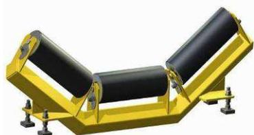
在参考澳大利亚 CST 公司的工艺方案基础上完善而成。托辊组整体以及中支座、边支座均采用精密加工且连续可调，全面支持准直度调整。轴向窜动及径向跳动分别不大于 0.5mm 和 0.2mm。
