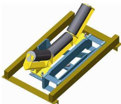
根据用户对计量精度的要求和现场运行条件,配置 1、2、3、4 个模块组成悬浮式单托辊或多托辊秤。ICS-MK 模块式皮带秤采用平形四边形受力结构,称重托辊是通过上、下簧片加力到传感器,大大提高了抗偏载能力。这种结构,可以节省皮带秤安装、准直的时间,降低装调费用。特别是在欧、美国家,由于人工费很贵,安装传统具有秤桥的秤,由于秤架较重,往往需要起吊机械,加上使用垫片来调引导托辊与称重秤桥的平直,非常麻烦和费时,有时会使安装费用高于皮带秤本身的价格。由于模块式皮带秤可以显著提高准直精度,大大降低了皮带垂直方向的跑去所造成的反作用力以及皮带张力的影响,且
